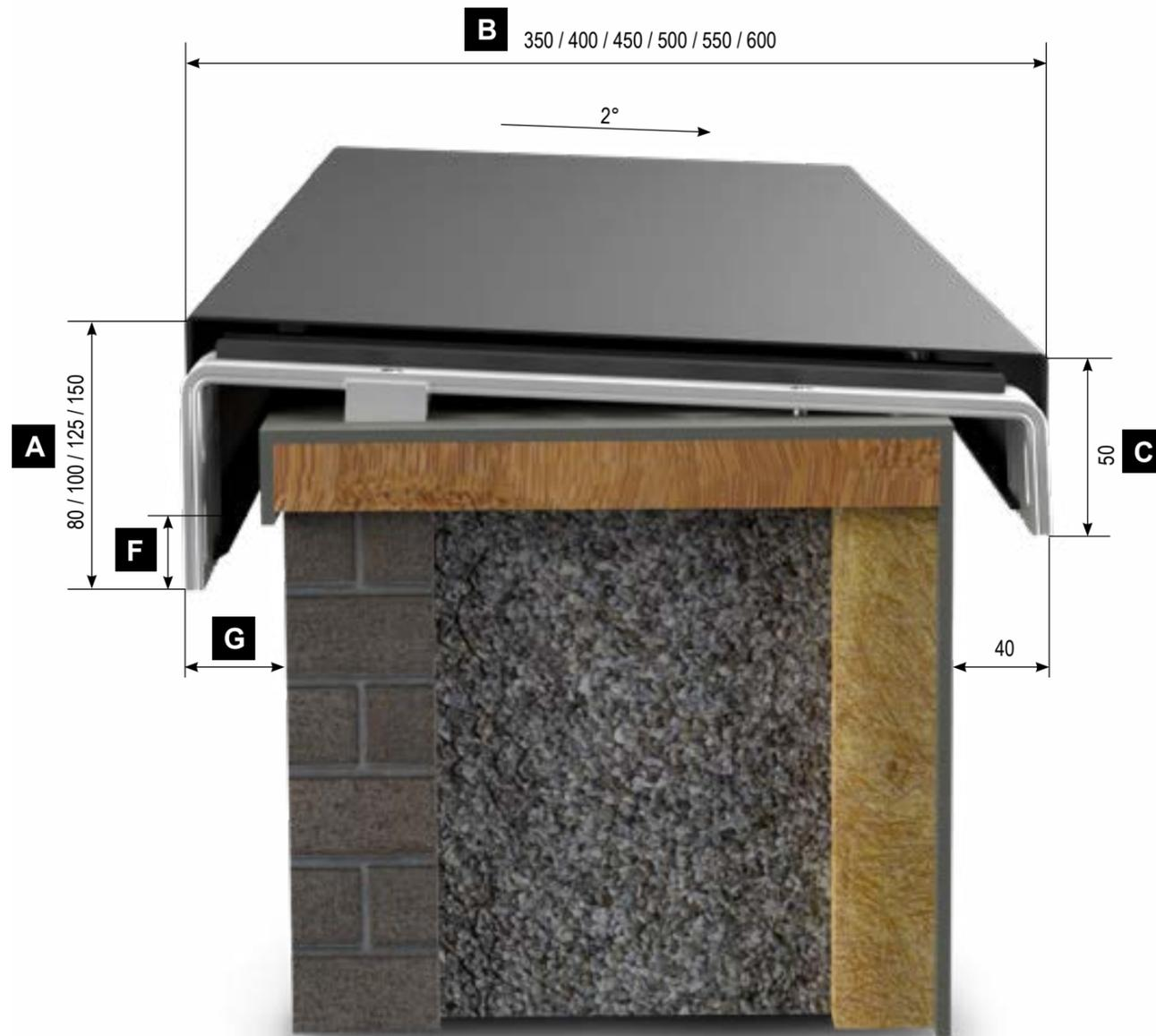
**A** ANSICHT    **B** KRONENBREITE    **C** DACHSEITE    **F** ÜBERDECKUNG
